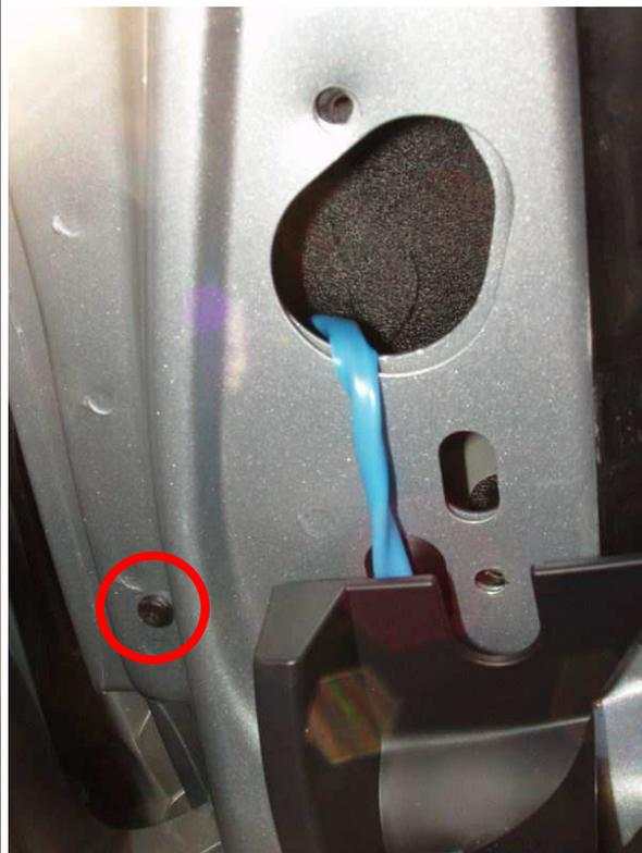
Plus qu'à décliper le rétro en appuyant, avec le tournevis plat à cet endroit :
